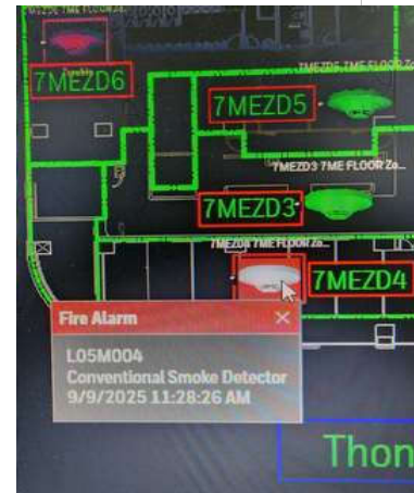
Central Computer แสดงตำแหน่ง Zone Alarm
