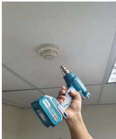
ทดสอบการทำงาน Heat detector
